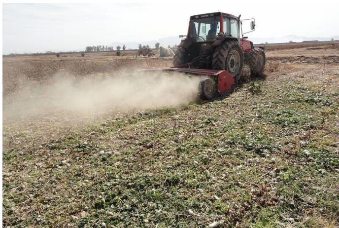
شکل ۱۰- خرد کردن بقایای پنبه با استفاده از ساقه خردکن پشت تراکتوری
