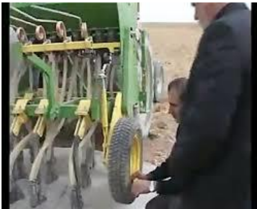
شکل ۱۲- کالیبره کردن کارنده به روش آزمایشگاهی
