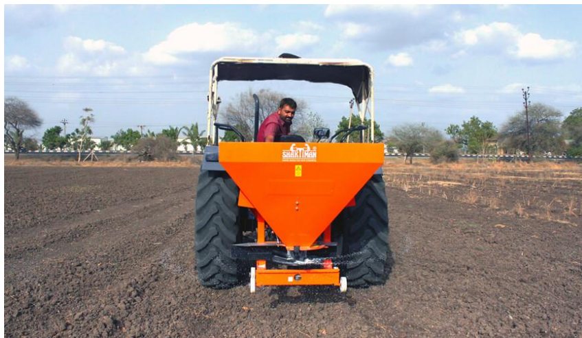
شکل ۳- کودپاش سانتریفیوژ که به عنوان بذرپاش هم استفاده می‌شود
